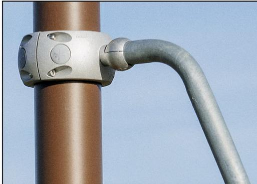
Les composants en acier coloré ont une base de galvanisation à chaud et une finition supérieure revêtue de poudre. Cela offre une résistance ultime à la corrosion dans tous les climats du monde. Les autres surfaces en acier sont galvanisées à chaud à l'intérieur et à l'extérieur avec du zinc sans plomb.
