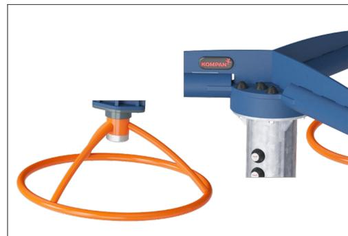
Sistema di cuscinetti progettato per impieghi gravosi con due cuscinetti radiali a una corona di sfere ad alta qualità con tenute in gomma. La struttura del cuscinetto completamente chiusa è lubrificata a vita e posizionata fuori terra.
