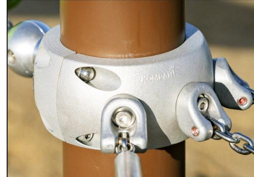
Les pinces intelligentes Corocord sont soigneusement conçues dans les moindres détails pour assurer une flexibilité supérieure dans un matériau en aluminium de haute qualité. Les pinces intelligentes sont fixées autour des poteaux avec quatre boulons en acier. Les points d'attache non utilisés sont fermés par des capuchons en polyamide (PA).
