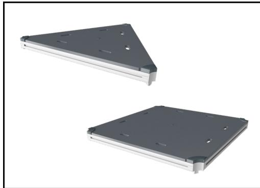
Všechny plošiny jsou podporovány unikátně navrženými nízkouhlíkovými hliníkovými profily s více možnostmi uchycení. Šedé zbarvené lisované plošiny jsou vyrobeny ze 75 % z PP materiálu z post-spotřebitelského odpadu s protiskluzovým vzorem a texturou povrchu.
