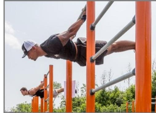
Toutes les barres destinées aux tractions sont faites de solides barres d'acier S235JR galvanisées par immersion à chaud d'un diamètre de 32 mm x 138 m. C'est le diamètre idéal pour une bonne prise en main pour tous.
