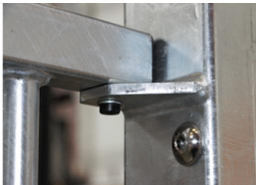
Tous les composants en acier sont fabriqués en acier carbone, soudés en conformité avec la norme EN ISO 5817 et galvanisés à chaud (HDG) selon la norme ISO1461. Ce processus assure une bonne protection en toutes circonstances.
