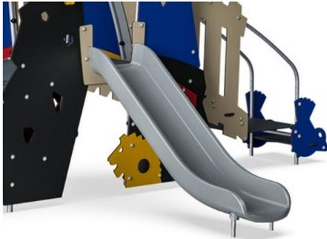
Die Rutsche besteht aus geformtem PE (Polyethylen) aus 33% Post-Consumer-Materialien in einem Stück mit einer Wandstärke von mindestens 5 mm und in verschiedenen Farben. Das PE ist auf UV-Beständigkeit getestet und hat eine ausgezeichnete Schlagzähigkeit und ist innerhalb einer großen Temperaturspanne verwendbar.
