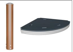
Les plateformes ELEMENTS sont fabriquées en HPL de 17,8 mm d'épaisseur, soutenus par un cadre en aluminium spécialement conçu, avec de multiples options de fixation grâce à des connecteurs en aluminium. Les poteaux principaux sont fabriqués en acier prégalvanisé de haute qualité recouvert d'une finition de surface par thermolaquage. La partie supérieure des poteaux est fermée au moyen de capuchons de nylon avec stabilisation UV (PA6).
