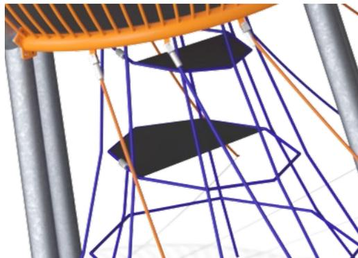
Corocord 软膜使用输送带质量的抗磨橡胶材料制成，具有出色的抗紫外线。经过测试并符合 PAH 的 REACH 要求。内嵌物为聚酯编织物制成的四层铠装。铠装层和两个表面层的总厚度为 7.5 mm。
