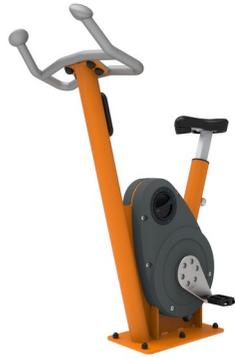
Der Rahmen ist aus feuerverzinktem Stahlrohr S235 mit den Abmessungen Ø76,1 x 3,6 mm und mit einer Pulverbeschichtung der Korrosionsklasse C3 nach ISO12944-2.
