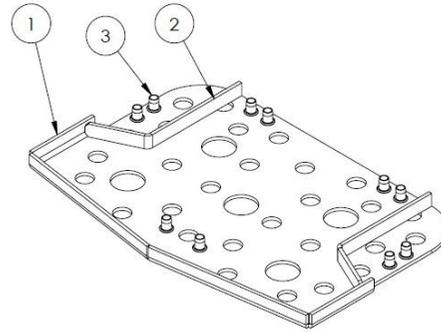
Ein 5 mm dickes, feuerverzinktes Baustahlblech ist in den Synthekautschuk eingeformt, um die Stabilität und die Einförmigkeit der Stufe in den Rahmen zu optimieren.
