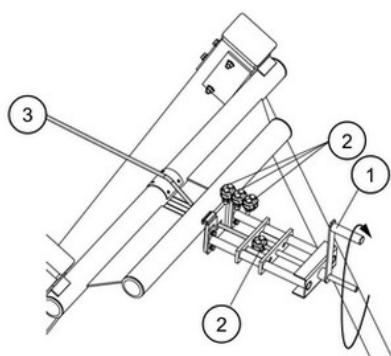
高品质的直径为 12mm 的钢缆设计适用于频繁使用的滑索。起点由旋钮指示。在停止点处有专门设计的弹簧装置，可确保拉拔器的停止更为柔和。
