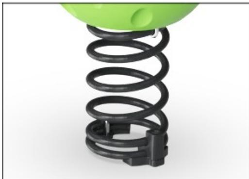
Los muelles KOMPAN están hechos de acero de resorte de alta calidad según EN10270. Los muelles se limpian mediante fosfatación antes de pintarlos con una imprimación epoxi y un recubrimiento de poliéster en polvo como acabado superior. Los muelles se fijan mediante accesorios anti-pelliczos únicos para máxima seguridad y larga vida útil.
