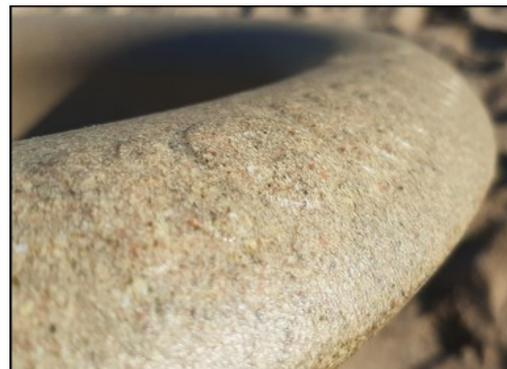
La variante de color arena está hecha de material de PE mezclado con piedra rotomoldeada con textura de superficie antideslizante. Se esperan pequeñas diferencias en la visualidad de la mezcla de piedra del material.
