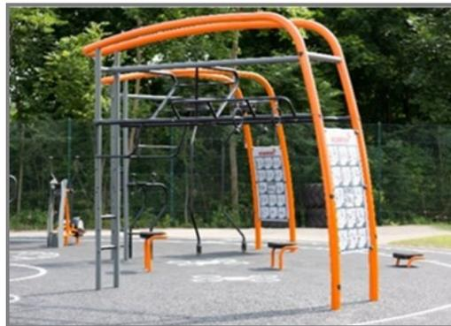
Per garantire l'integrità del telaio principale, i montanti principali di colore arancione sono realizzati con montanti in acciaio 101,6 x 3 mm, zincati a caldo e verniciati a polvere arancione (RAL2010). I pali di sostegno ricevono lo stesso trattamento superficiale e sono realizzati in tubi di acciaio 76,1 x 3,6 mm, verniciati a polvere in grigio (RAL7012).
