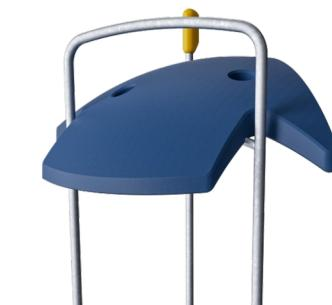
Střechy řady ELEMENTS jsou vyrobeny z recyklovatelného PE z 33 % tvořeného post-spotřebními materiály s minimální tloušťkou stěny 5 mm, aby byla zajištěna vysoká životnost ve všech klimatických podmínkách po celém světě. Ocelové trubky jsou žárově zinkované uvnitř i vně, aby byla zajištěna maximální životnost.
