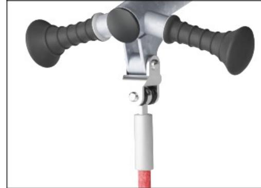
Die angewinkelten Griffe sind aus Polypropylen (PP) gefertigt und mit einer weichen TPV-Gummibeschichtung versehen. Der Griff ist mit einer verzinkten Stahleinlage am Rohr befestigt, um einen dauerhaften Halt zu gewährleisten.
