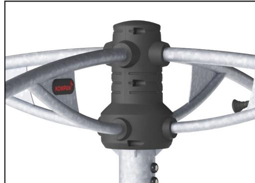
Lagersystem mit einreihigen Rillenkugellagern und Gummidichtungen. Die komplett geschlossene Lagerkonstruktion ist dauergeschmiert und wartungsfrei.
