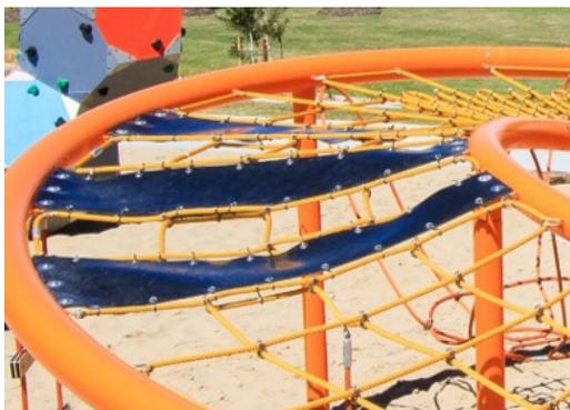
Corocord 软膜使用输送带质量的抗磨橡胶材料制成，具有出色的抗紫线性。经过测试并符合 PAH 的 REACH 要求。内嵌物为聚酯编织物制成的四层铠装。铠装层和两个表面层的总厚度为 7.5 mm。
