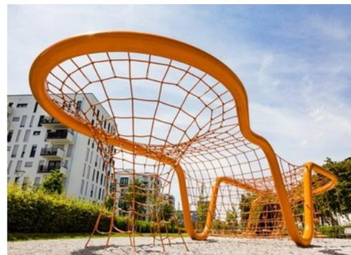
这些弯曲钢管的钢表面湿涂了一层无铅彩色材料的基础层和一层顶层。该涂料具有出色的耐腐蚀性，并且易于维护。
