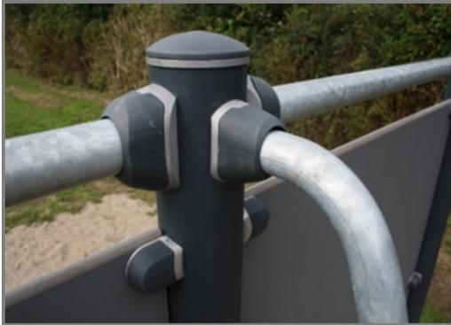
Die Verbinder sind aus druckgegossenem Aluminium hergestellt, das speziell für den Aussenbereich und starke Beanspruchung legiert ist. Die Schrauben zur Befestigung der Verbinder sind aus Edelstahl und durch Zink-Unterlegscheiben geschützt.
