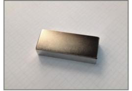
Les aimants utilisés sont au néodyme à haute énergie. Le rayonnement magnétique est rigoureusement contrôlé, il ne dépasse jamais 5 gauss (0,5mT), ce qui les rend parfaitement sûrs à utiliser dans le cadre d'un entrainement.
