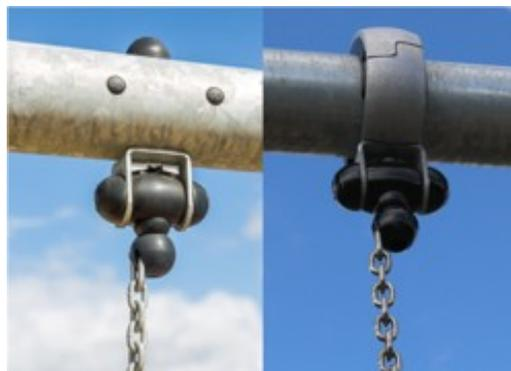
Die Schaukelauflösungen bestehen aus einem hochwertigen und UV-beständigem Nylon (PA6) Gehäuse mit integrierten dauergeschmierten Kugellagern. Die höhenverstellbaren Ketten werden durch Edelstahl-Haken angebracht, die diebstahlgesichert und mit einem Anti-Überschlag-Gehäuse versehen sind. Alle Sitze mit zwei Kettenauflösungen sind erhältlich mit Standard-/ oder Anti-Überschlag-Auflösung.
