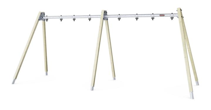
KOMPAN 秋千可根据客户需要和要求进行配置。 所有 A 型框架秋千的高度有 2.0 米和 2.5 米 两种,支柱采用浸渍松木或热浸镀锌钢。关于座 椅,我们提供直径为 100 厘米或 120 厘米的 标准秋千座椅、摇篮座椅、幼儿座椅或 bird nests。此外,我们还提供热浸镀锌链条或不锈 钢链条,以及防缠绕悬挂装置。我们的秋干还可 以增加 2、3、4 或更多节的多层配置。
