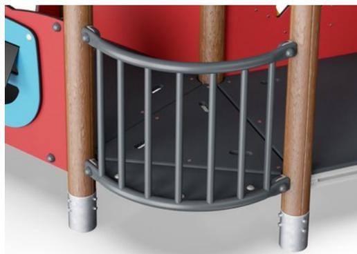
Los componentes de acero coloreado tienen una base de galvanización en caliente y un acabado superior con recubrimiento en polvo. Esto proporciona una máxima resistencia a la corrosión en todos los climas del mundo.
