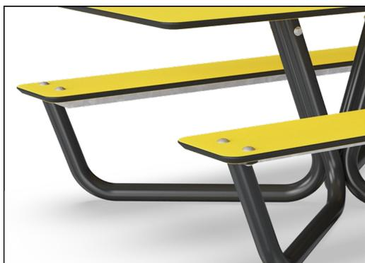
Toutes les planches sont fabriquées en stratifié haute pression HPL d'une épaisseur de 17,8 mm selon la norme EN 438-6 et ont une texture de surface antidérapante. La construction multicouche rend les panneaux durables et adaptés à une utilisation en extérieur avec une grande stabilité aux UV et une haute résistance aux chocs, aux rayures, au feu, à l'eau et à l'humidité.
