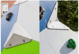
Soportes de esquina fundidos a presión de aluminio sin plomo de alta calidad. Los soportes de esquina tienen bordes muy redondeados y tornillos de acero inoxidable avellanados. Para entornos soleados, el soporte de esquina puede suministrarse con un recubrimiento en polvo opcional que reduce la absorción de calor de los soportes.
