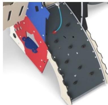
曲线攀登墙由 Ekogrip® 面板组成，该面板由 15mm 厚的聚乙烯底座和 3mm 厚的软橡胶制成，具有防滑效果。
