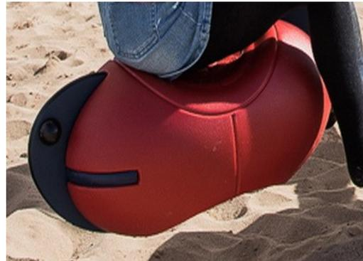
Der Sitz besteht aus recycelbarem PE mit einem Anteil von 33 % Post-Consumer-Materialien und ist in einem Stück formgepresst (Mindestwandstärke von 5 mm). PE hat eine hohe Schlagfestigkeit über eine große Temperaturspanne, was Vandalismussicherheit an allen Standorten gewährleistet.
