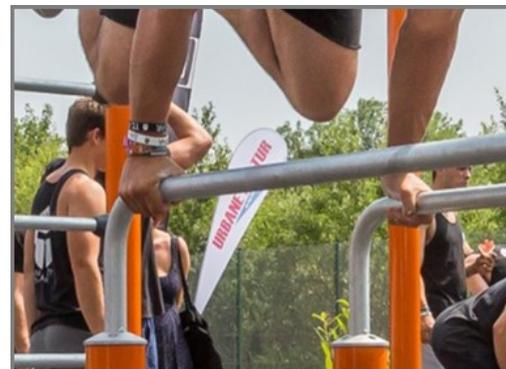
Les barres conçues pour les exercices sont faites d'acier galvanisé par immersion à chaud de Ø38 mm. Un diamètre idéal pour soutenir le poignet pendant les dips ou les appuis tendus renversés.
