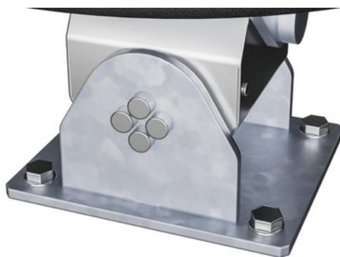
Das doppelte ROSTA-Element ist aus Gusseisen hergestellt und wurde vor dem Lackieren feuerverzinkt. Dies gewährleistet, dass das ROSTA-Element ein wartungsfreies, elastisches Gelenk ist, das in einem Bereich von 250 in jede Richtung bewegt werden kann. Beide Taumelscheiben haben eine unterschiedliche Steifigkeit, der Unterschied beträgt 45%.
