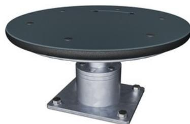
Bei den im Twist verwendeten Lagern handelt es sich um Gleitlager aus Polyoxymethylen, einem Material, das alle für ein starkes Lager erforderlichen Eigenschaften aufweist: extrem geringer Verschleiß, hohe mechanische Festigkeit, geringe Feuchtigkeitsaufnahme und hohe Abriebfestigkeit.
