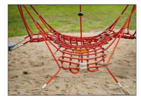
Seile aus UV-stabilisierten PES-Seilsträngen mit innerer Stahlseilverstärkung. Das Polyestergarn besteht aus +95% Post-Consumer-Materialien und wird induktiv auf jede Litze aufgeschmolzen, um eine hervorragende Verschleissfestigkeit zu erreichen.
