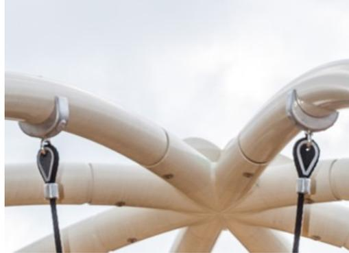
Corocord-Klemmen aus Aluminium werden als Verbindungselemente zwischen Stahlposten und dem Seil verwendet. Das Aluminium-Formteil wird in den Stahlposten eingeschraubt und ist sicher mit dem Seil verbunden.
