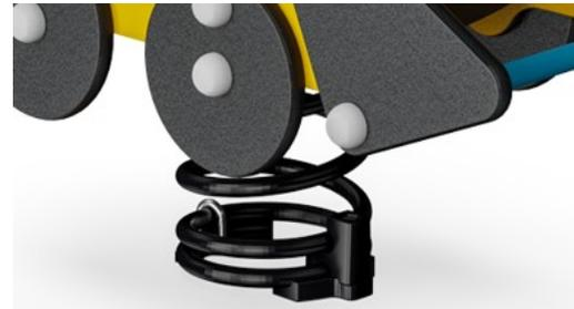
KOMPAN Federn bestehen aus hochwertigem Federstahl nach EN 10270-1. Die Federn werden durch Phosphatierung gereinigt, bevor sie mit einer Epoxid-Grundierung und Polyester-Beschichtung überzogen werden. Die Federn werden mit speziellen Klemmschutz-Elementen angebracht, um für höchste Sicherheit und eine hohe Lebensdauer zu sorgen.
