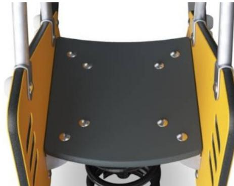
Der Sitz besteht aus einer Ekogrip® Platte, die aus einer 15 mm dicken PE -Fläche und einer 3 mm dicken Gummibeschichtung gefertigt ist, welche für einen Anti-Rutsch-Effekt sorgt.
