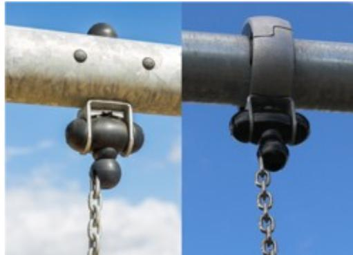
Die Schaukelaufhänger bestehen aus einem hochwertigen und UV-beständigem Nylon (PA6) Gehäuse mit integrierten dauergeschmierten Kugellagern. Die höhenverstellbaren Ketten werden durch Edelstahl-Haken angebracht, die diebstahlgesichert und mit einem Anti-Überschlag-Gehäuse versehen sind. Alle Sitze mit zwei Kettenaufhängungen sind erhältlich mit Standard-/ oder Anti-Überschlag-Aufhängung.
