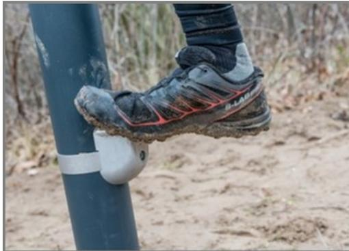
台阶由挤压铝制成，表面防滑。铝具有很高的耐腐蚀性，保证了产品的耐久性。台阶安装在 34.7cm 和 54.7cm 的高度上，这样可以方便地到达顶部活动区域。
