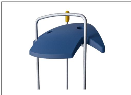
Střechy řady ELEMENTS jsou vyrobeny z recyklovatelného PE z 33 % tvořeného post-spotřebními materiály s minimální tloušťkou stěny 5 mm, aby byla zajištěna vysoká životnost ve všech klimatických podmínkách po celém světě. Ocelové trubky jsou žárově zinkovány uvnitř i vně, aby byla zajištěna maximální životnost.
