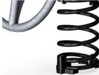
Le molle KOMPAN sono realizzate con acciaio per molle di alta qualità secondo EN10270. Le molle vengono pulite mediante fosfatazione prima di essere verniciate con un primer epossidico e un rivestimento in polvere di poliestere come finitura superiore. Le molle sono fissate da esclusivi raccordi anti pizzico per la massima sicurezza e lunga durata.
