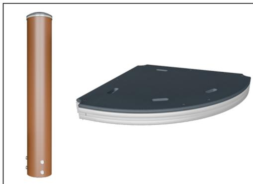
Les plateformes ELEMENTS sont fabriquées en HPL de 17,8 mm d'épaisseur, soutenues par un cadre en aluminium spécialement conçu, avec de multiples options de fixation grâce à des connecteurs en aluminium. Les poteaux principaux sont fabriqués en acier prégalvanisé de haute qualité recouvert d'une finition de surface par thermolaquage. La partie supérieure des poteaux est fermée au moyen de capuchons de nylon avec stabilisation UV (PA6).
