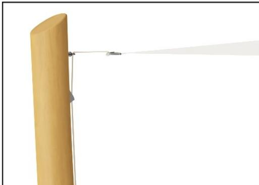
Das Seil wird mit einer Edelstahl-Ösenschraube am Robinienposten befestigt und durch einen Nylon-Bügel mit Keilschiene gespannt. Das System sorgt dafür, dass sich das Segel leicht anbringen, spannen und wieder abnehmen lässt.
