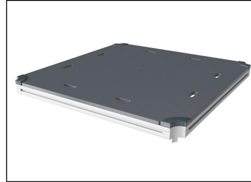
Alle Bodenplatten werden von einzigartig gestalteten kohlenstoffarm gefertigten Aluminiumprofilen und mehreren Befestigungen getragen. Die grau gefärbten, spritzgussgeformten Bodenplatten bestehen zu 75 % aus Post-Consumer-Abfällen (PP-Material) und haben ein rutschfestes Muster und eine strukturierte Oberfläche.
