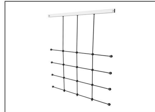
Kletternetze werden aus UV-stabilisiertem PP-Seil mit innerer Stahlseilverstärkung hergestellt. Das Seil ist induktionsbehandelt, um eine maximale Fixierung zwischen Stahl und Seil zu erreichen, was eine ausgezeichnete Verschleiss- und Reißfestigkeit bietet. Alle Seilverbinder sind aus 100% recyclebarem PA-Material hergestellt.
