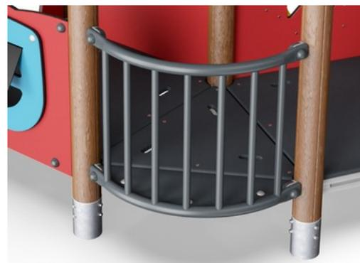
I componenti in acciaio colorato hanno una base di zincatura a caldo e una finitura superiore verniciata a polvere. Ciò fornisce la massima resistenza alla corrosione in tutti i climi del mondo.
