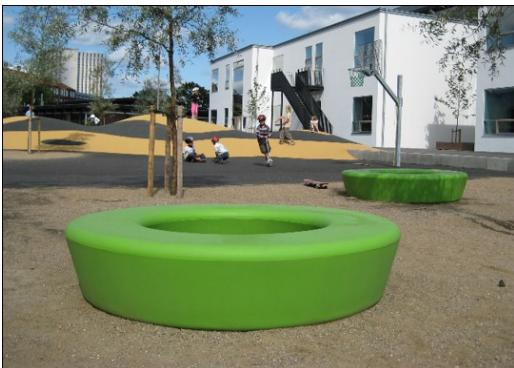
Loop lze připevnit k povrchu naplněním jejich vnitřních prostor vodou nebo pískem pomocí integrovaných zátek. Případně je možno je upevnit použitím povrchových nebo zemních držáků.
