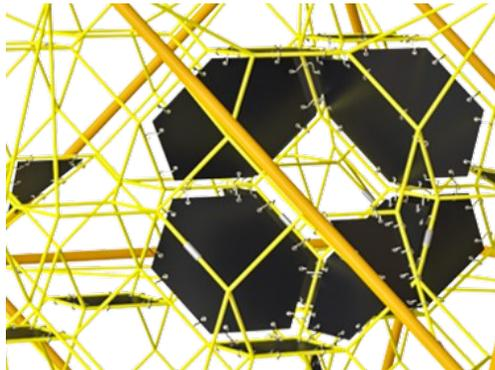
Die Corocord Membranen bestehen aus rutschfestem, gummiertem Material in Förderband-Qualität, das eine exzellente UV-Beständigkeit aufweist. Die geprüfte Konformität mit den REACH-Anforderungen für PAK ist gegeben. In die Membranen ist eine vierlagige Armierung aus gewebtem Polyester eingebettet. Die Armierung und die doppelte Oberflächenschicht ergeben eine Gesamtstärke von 7,5 mm.
