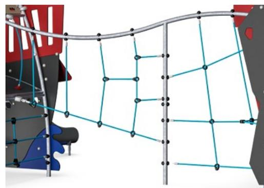
Die Seile sind aus UV-stabilisierten PP-Seilsträngen mit innerer Stahlseilverstärkung gefertigt. Die horizontalen Seile sind PUR-beschichtet, um eine gute Verschleißfestigkeit zu erreichen.
