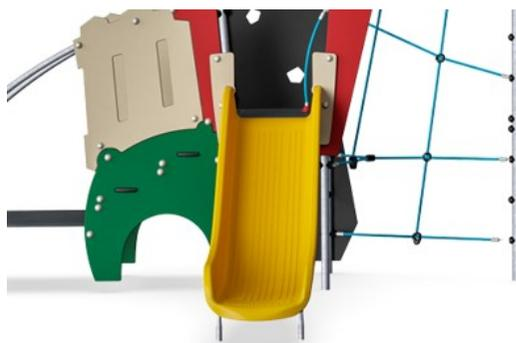
Die Rutsche besteht aus geformtem PE (Polyethylen) aus 33% Post-Consumer-Materialien in einem Stück mit einer Wandstärke von mindestens 5 mm und in verschiedenen Farben. Das PE ist auf UV-Beständigkeit getestet und hat eine ausgezeichnete Schlagzähigkeit und ist innerhalb einer großen Temperaturspanne verwendbar.
