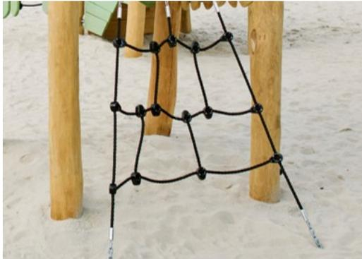
Las redes y cuerdas están hechas de PA estabilizado a los rayos UV con refuerzo interno de cable de acero. El cable se trata por inducción para crear una conexión fuerte entre el acero y el cable que conduce a una buena resistencia al desgaste.
