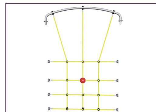
Lana řady ELEMENTS obsahují šestipramenné ocelové dráty a ocelové drátěné jádro. Každý pramen je pevně obalen PES vláknem, které je z více než 95% tvořeno post-spotřebními materiály. Vlákno je nataveno na každý jednotlivý pramen, takže lana jsou vysoko odolná proti opotřebení a vandalismu.
