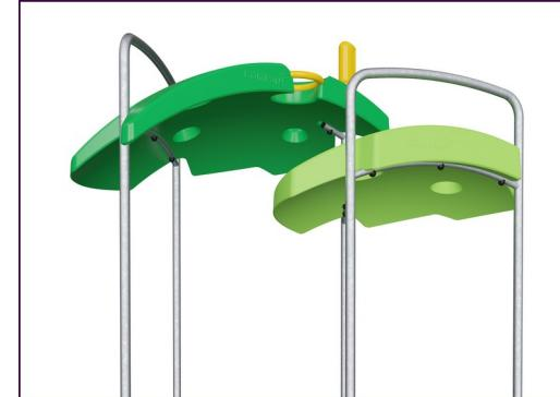
Střechy řady ELEMENTS jsou vyrobeny z recyklovatelného PE z 33 % tvořeného post-spotřebními materiály s minimální tloušťkou stěny 5 mm, aby byla zajištěna vysoká životnost ve všech klimatických podmínkách po celém světě. Ocelové trubky jsou žárově zinkovány uvnitř i vně, aby byla zajištěna maximální životnost.
