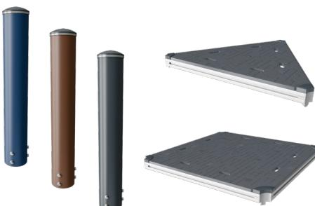
Hlavní sloupy jsou vyrobeny z vysoko kvalitní pozinkované oceli s povrchovou úpravou práškovým lakem. Vrcholy sloupků jsou uzavřeny krytkami z UV stabilizovaného nylonu (PA6). Tvarované šedé desky jsou vyrobeny ze 75 % z postkonzumního odpadu PP materiálu s protiskluzovým vzorem a strukturovaným povrchem. Všechny desky jsou podepřeny unikátně navrženými nízkouhlíkovými bělenkovými lištami s několika možnostmi uchycení.
