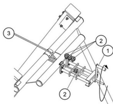
Le câble d'acier (3) est tendu par un dispositif spécialement conçu. En tournant la poignée (1), le câble en acier peut être tendu conformément aux instructions et en toute sécurité. Après tension, le câble est verrouillé par trois serres-câble (2). Le dispositif de tension peut également être utilisé pour procéder au réglage lors des inspections annuelles.
