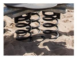
KOMPAN Federn bestehen aus hochwertigem Federstahl nach EN 10270-1. Die Federn werden durch Phosphatierung gereinigt, bevor sie mit einer Epoxid-Grundierung und Polyester-Beschichtung überzogen werden. Die Federn werden mit speziellen Klemmschutz-Elementen angebracht, um für höchste Sicherheit und eine hohe Lebensdauer zu sorgen.
