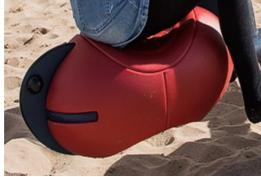
Der Sitz besteht aus recycelbarem PE mit einem Anteil von 33 % Post-Consumer-Materialien und ist in einem Stück formgepresst (Mindestwandstärke von 5 mm). PE hat eine hohe Schlagfestigkeit über eine große Temperaturspanne, was Vandalismussicherheit an allen Standorten gewährleistet.
