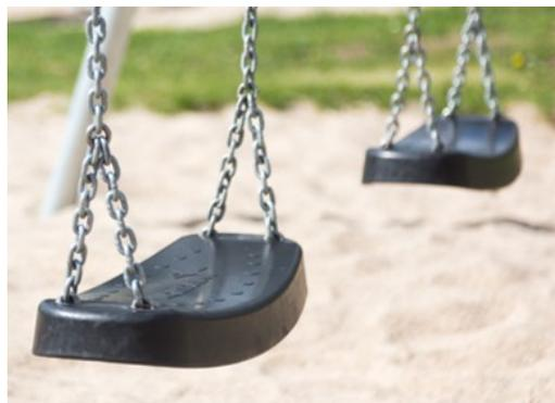
Los asientos estándar de los columpios KOMPAN están diseñados para una máxima seguridad y durabilidad. El asiento de dos componentes con núcleo interno de PP y goma exterior se produce en una sola operación. Los asientos están disponibles con cadenas oscilantes de acero galvanizado en caliente o de acero inoxidable para todas las alturas de los columpios.
