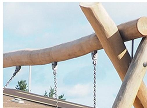
Los colgadores de los columpios están hechos de una carcasa de nylon de alta calidad estabilizada contra rayos UV (PA6) con rodamientos de bolas sellados de por vida integrados. Las cadenas ajustables en altura se fijan mediante un gancho de acero inoxidable con perno de ojo de serpiente antirrobo en una carcasa giratoria antivuelco.
