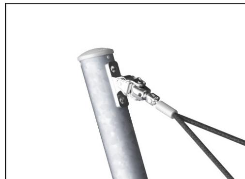
Die Bügelaufhängungen sind aus Edelstahlbügeln gefertigt und können über zwei Achsen bewegt werden. Die Flanschlager sind mit Silikon angereichert, um die Aufhängung wartungsfrei zu machen. An der Seilbefestigung befindet sich eine drehbare Verdrehsicherung, die ein Aufwickeln der Seile verhindert.
