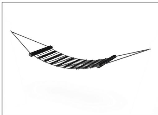
Die Hängematte besteht aus stahlverstärkten, einfach geflochtenen 16 mm starken, UV-stabilisierten PES-Seilen. Das Polyestergerne wird aus +95 % Post-Consumer-Materialien hergestellt und induktiv auf jede Litze aufgeschmolzen. PES hat eine hohe Festigkeit mit ausgezeichneter Beständigkeit gegen Abrieb und UV-Strahlung. Die Seilschlaufen sind mit Verbindern aus Nylon (PA6) verbunden, die für eine glatte und komfortable Hängematte sorgen.
