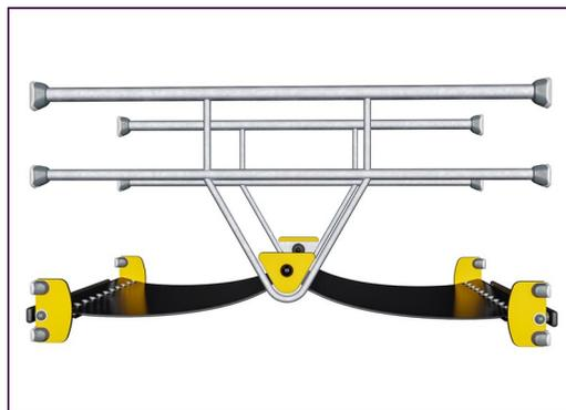
Las membranas de goma ELEMENTS son cintas transportadoras hechas de capas de goma mezcladas de goma natural y goma SBR, e incrustadas con capas de armadura de PE y PA tejidas. El grosor de 8 mm garantiza una alta durabilidad de cualquier entorno.
